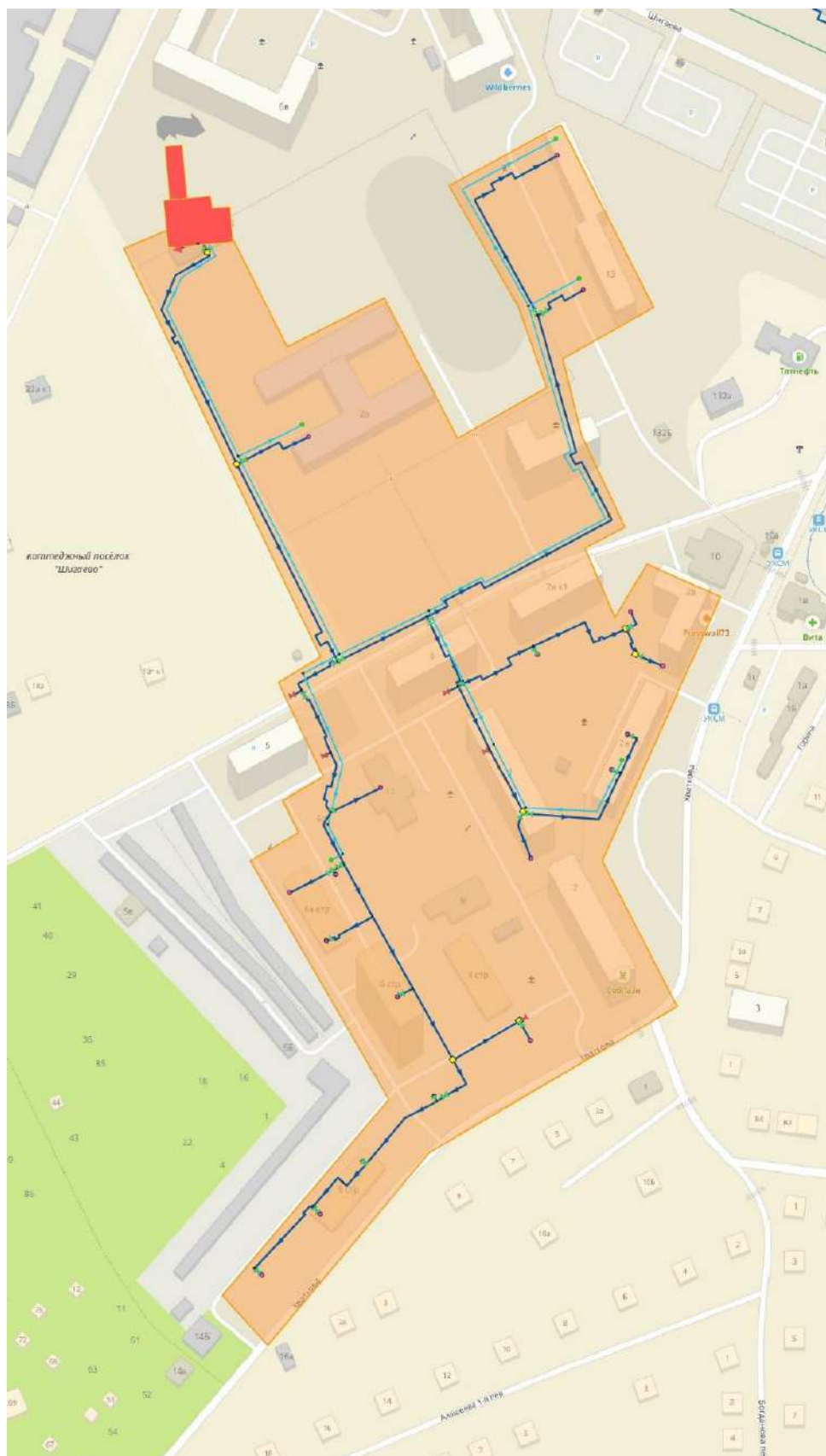
Рисунок 56 – Границы системы теплоснабжения котельной Школа №55
