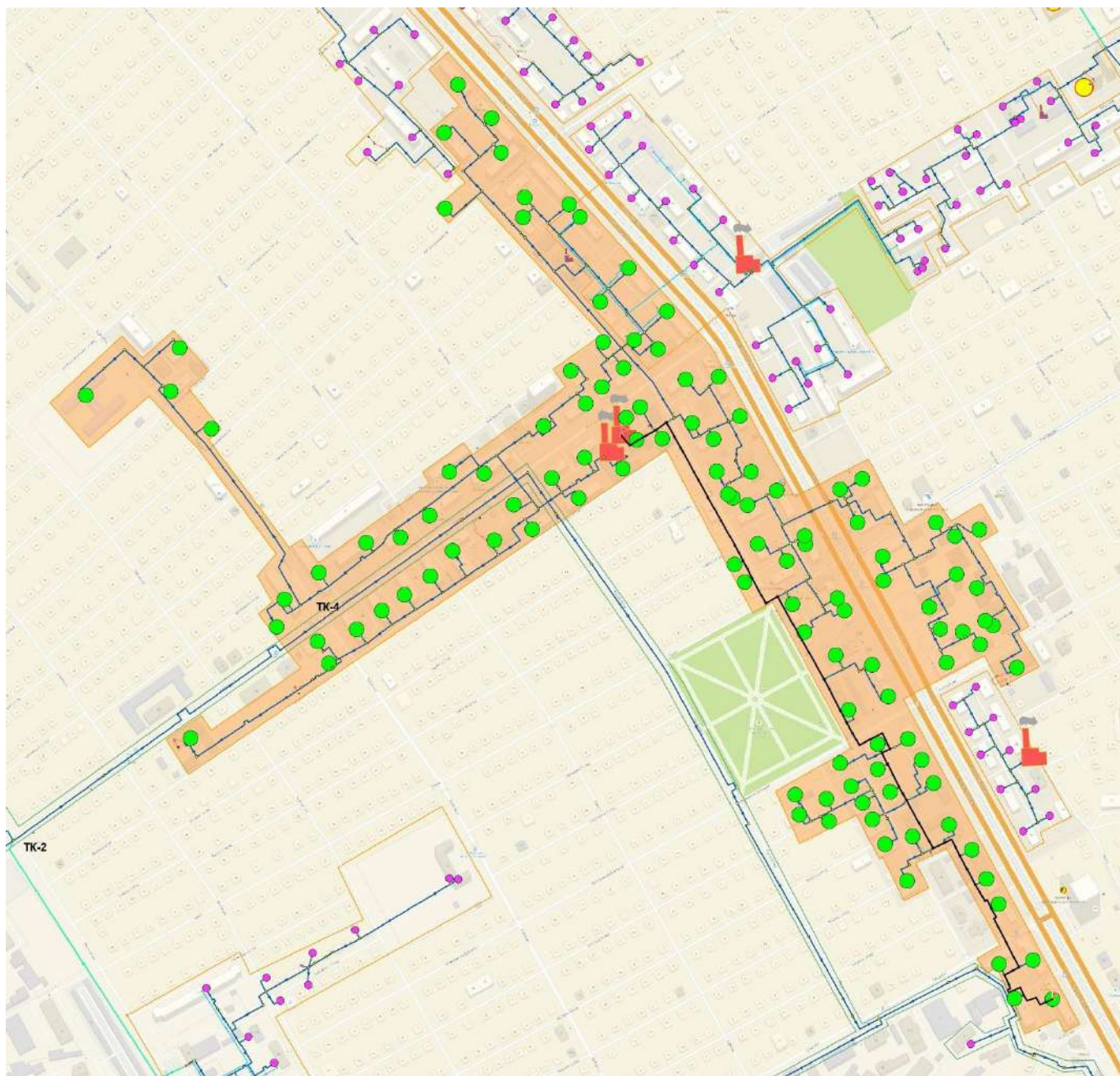
Рисунок 21 – Путь движения теплоносителя от источника тепловой энергии до конечного потребителя
