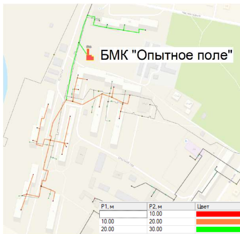
Рисунок 44 – Графическая интерпретация с располагаемым напором системы теплоснабжения котельной «Опытное поле».
