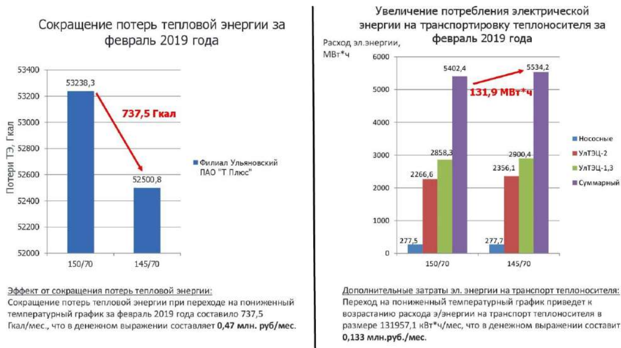
Рисунок 25 – Сравнение уменьшения потерь тепловой энергии и увеличения потребления электрической энергии на транспортировку теплоносителя при переходе с графика 150/70 на 145/70.
