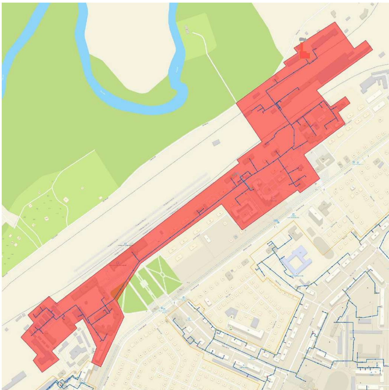
Рисунок 143 – Границы системы теплоснабжения котельной Центральная
