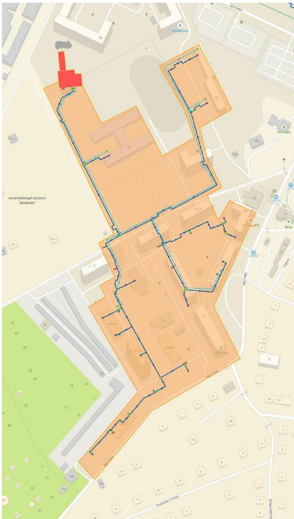
Рисунок 134 – Границы системы теплоснабжения котельной Школа №55
