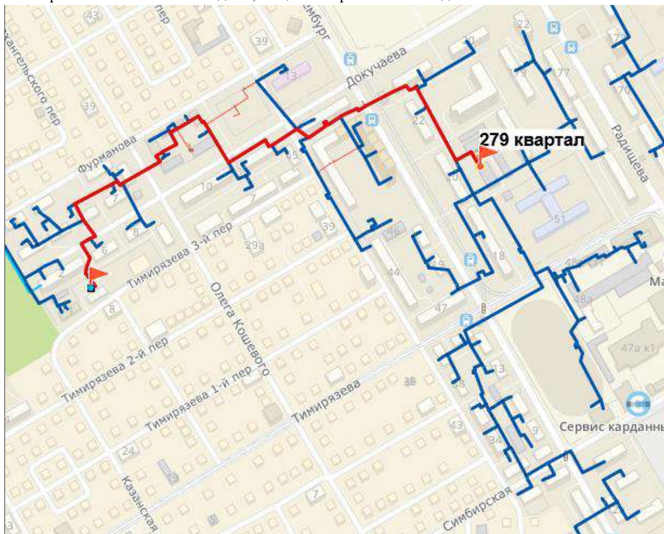
Рисунок 207 – Тепловые сети от котельной 279 кв. до наиболее отдалённого потребителя пер. Тимирязева, 3 (0,84 км).
