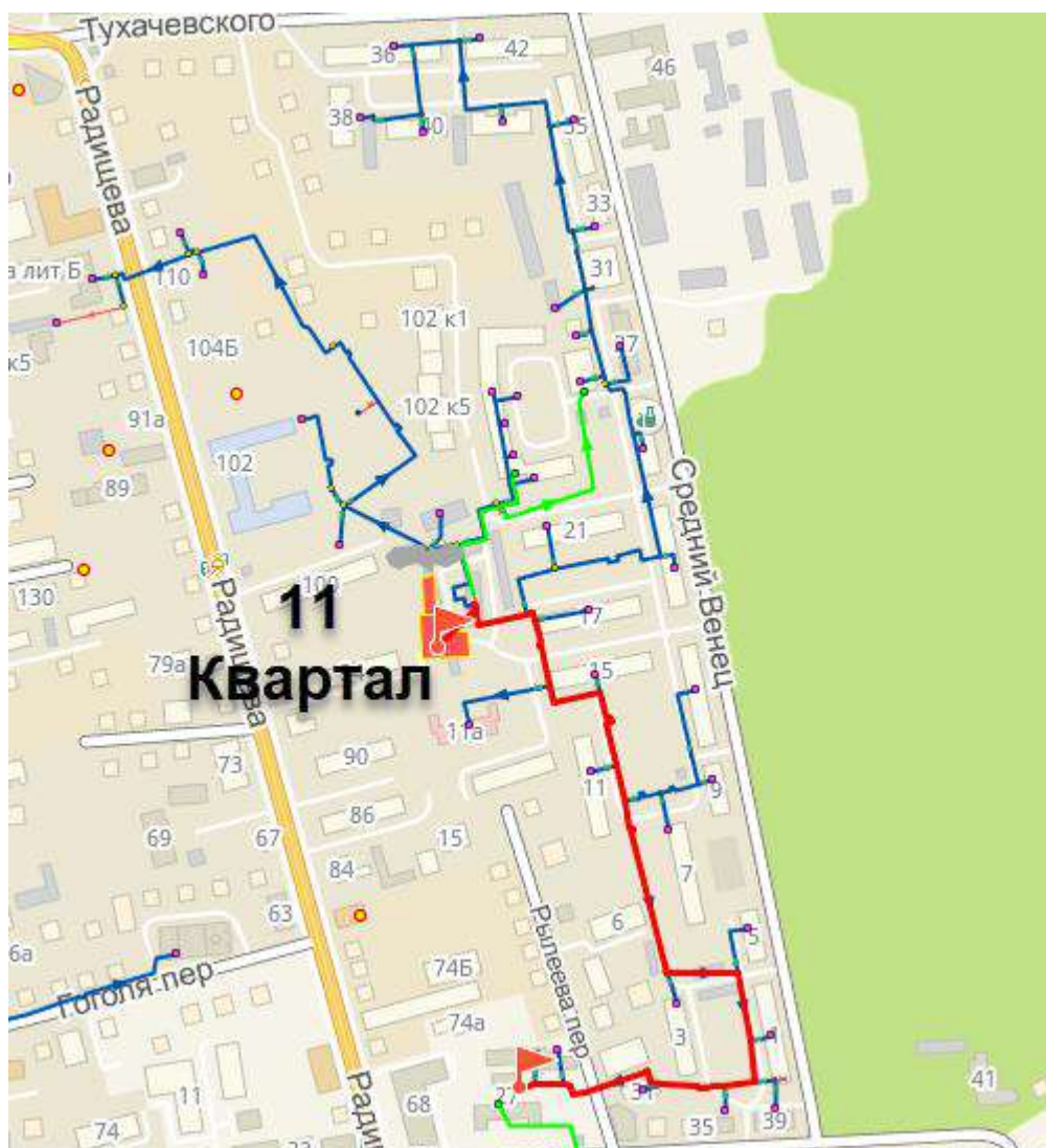
Рисунок 201 – Тепловые сети от котельной 11 кв. до наиболее отдалённого потребителя ул. Рылеева, 27 (0,7 км).
