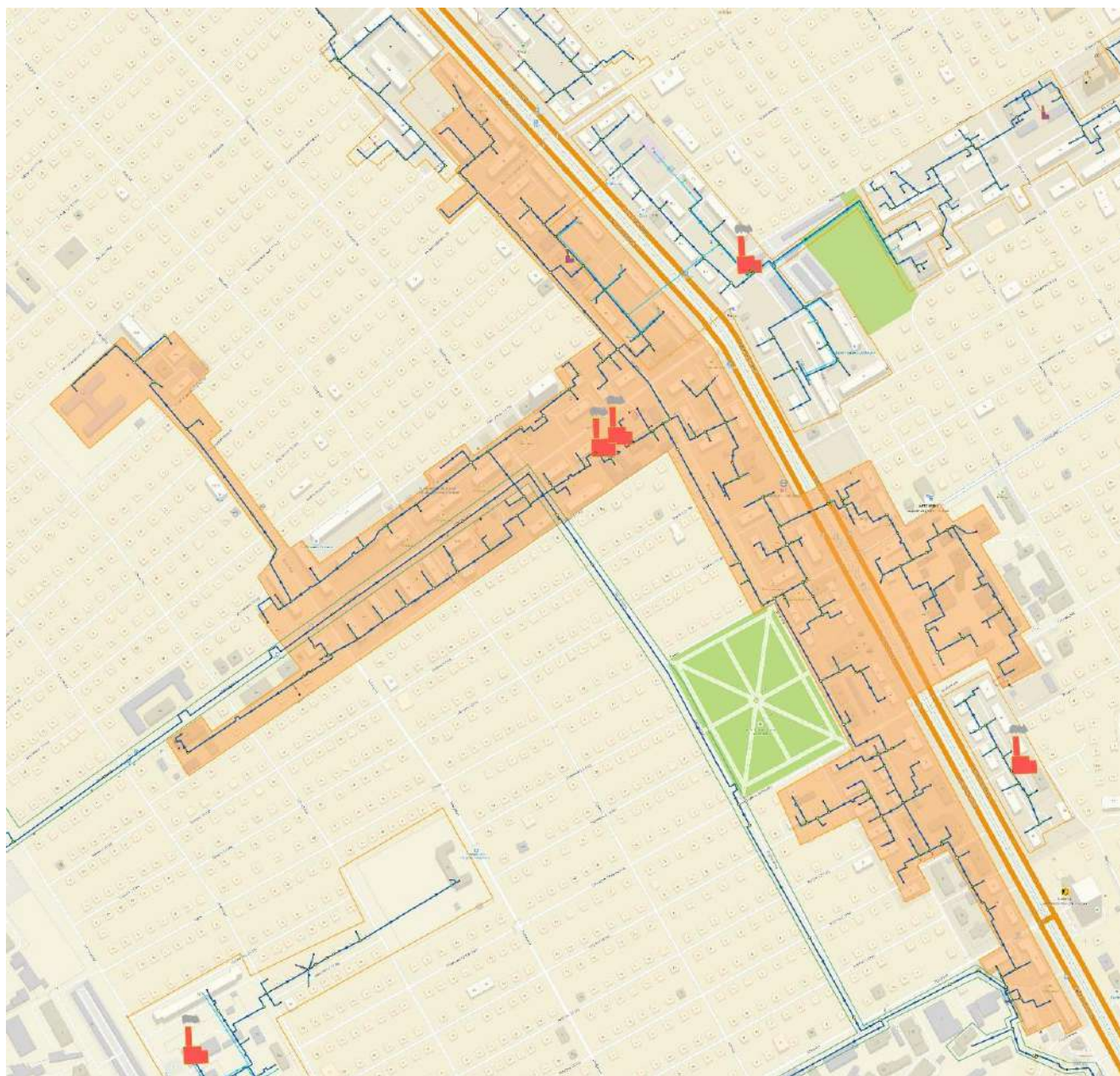
Рисунок 101 – Границы системы теплоснабжения котельной 298 кв.
