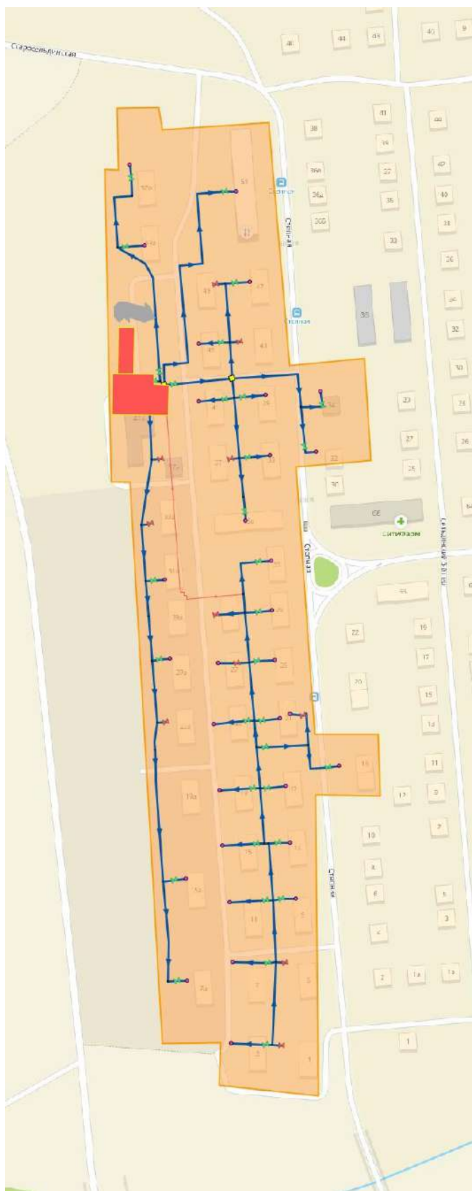
Рисунок 44 – Границы системы теплоснабжения котельной МО-92
