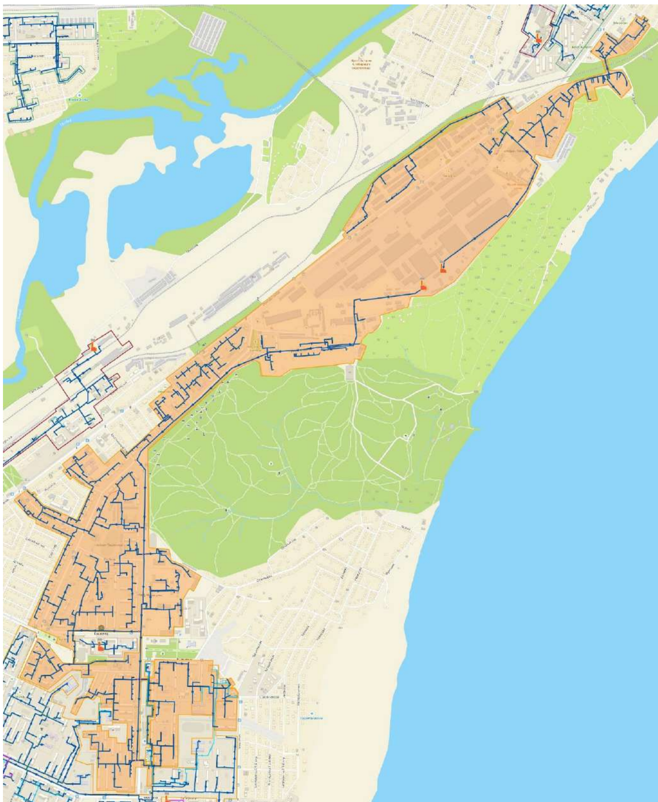
Рисунок 123 – Границы системы теплоснабжения котельной Моторный завод
