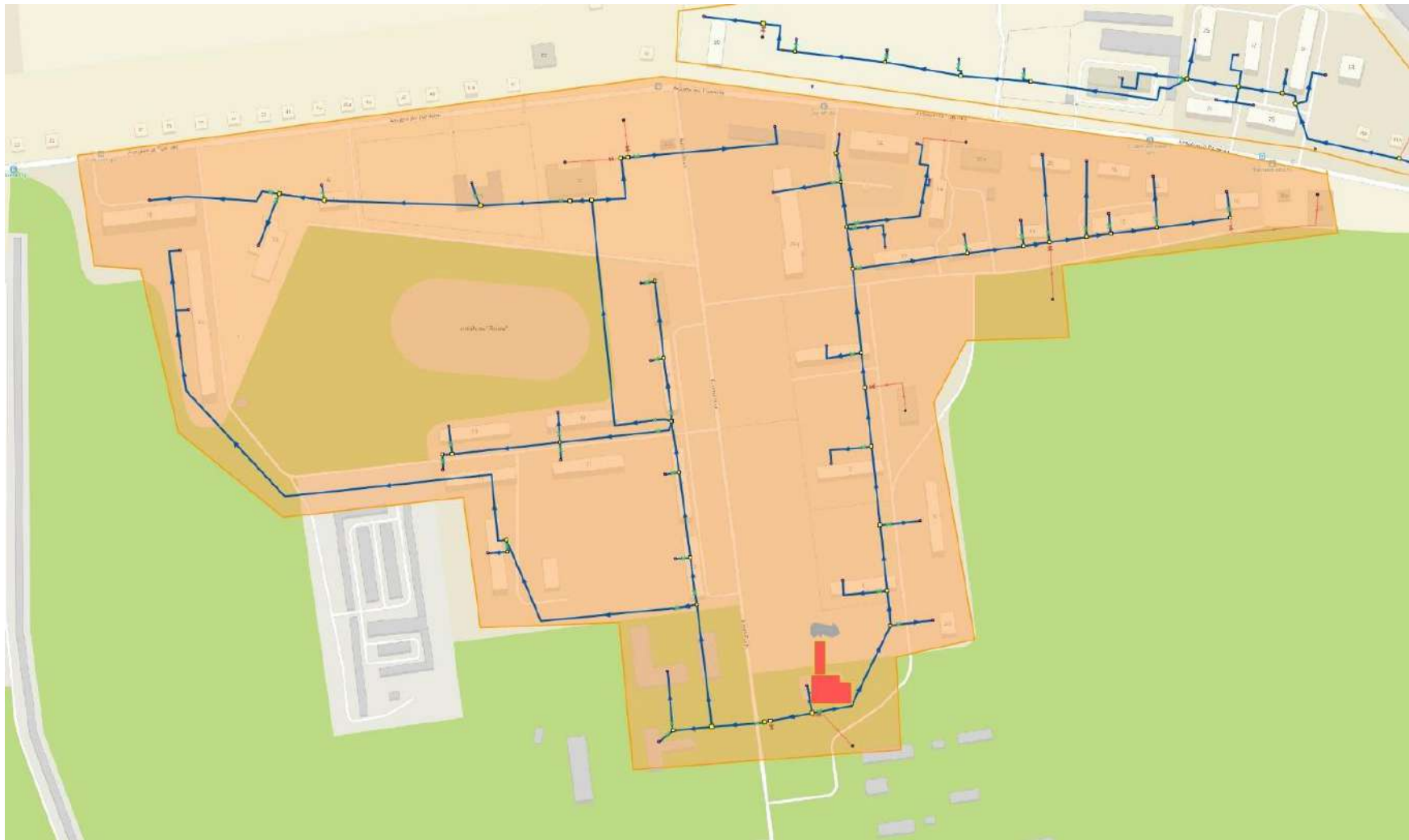
Рисунок 106 – Границы системы теплоснабжения котельной Арсенал
