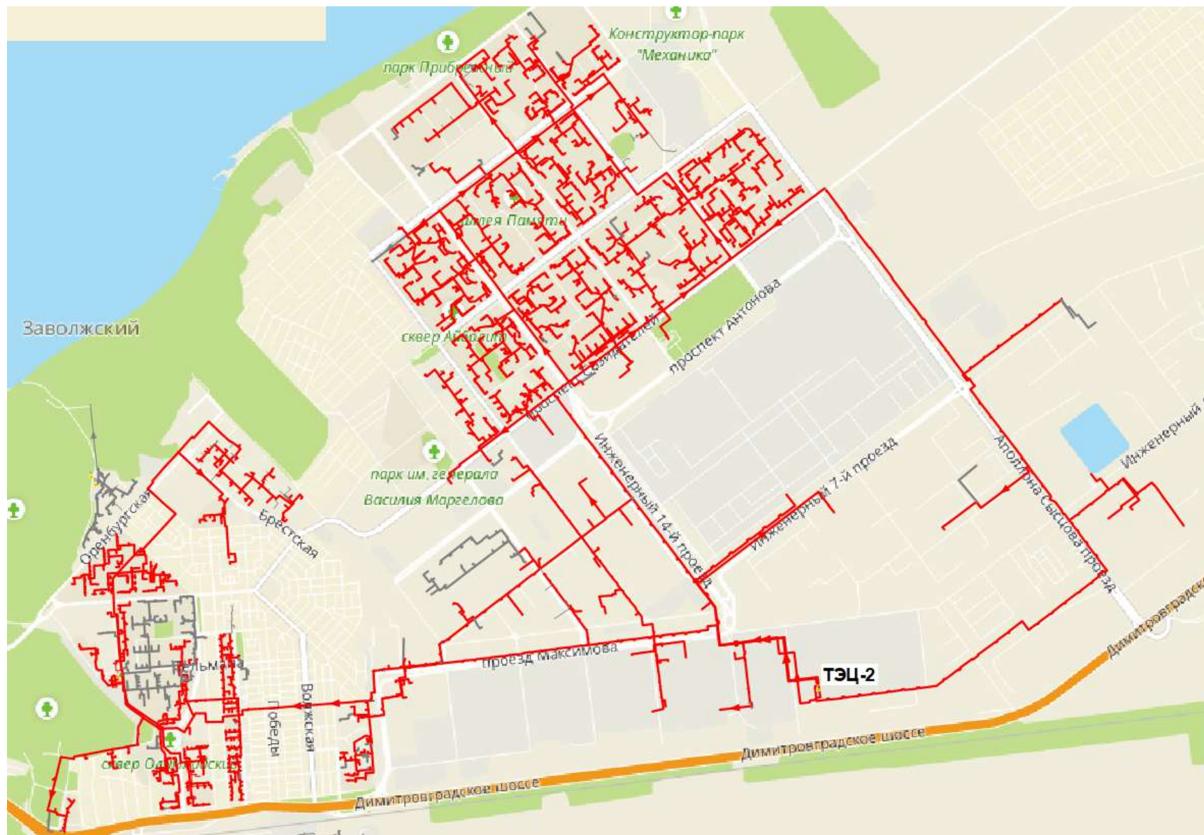
Рисунок 40 – Электронная модель тепловой сети от ТЭЦ-2, Левый берег Волги
