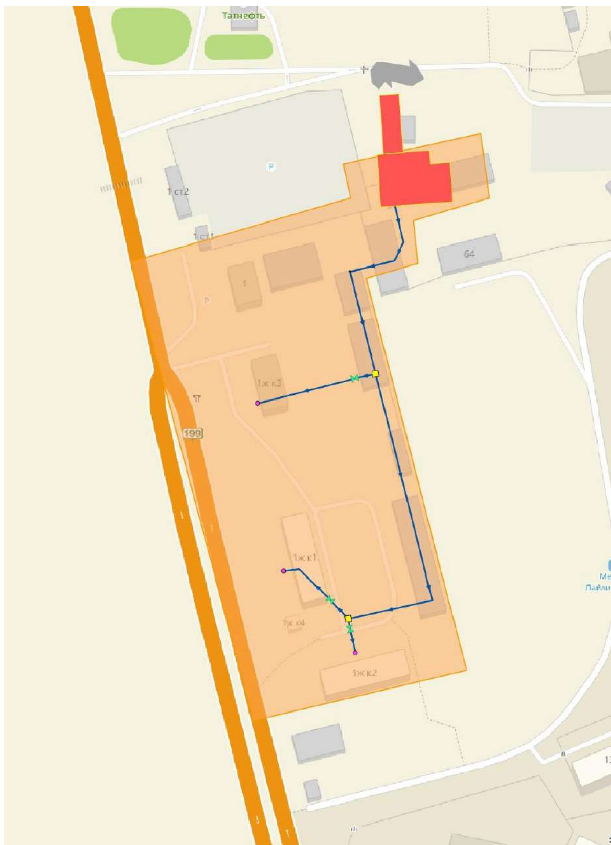
Рисунок 110 – Границы системы теплоснабжения котельной ДЭП
