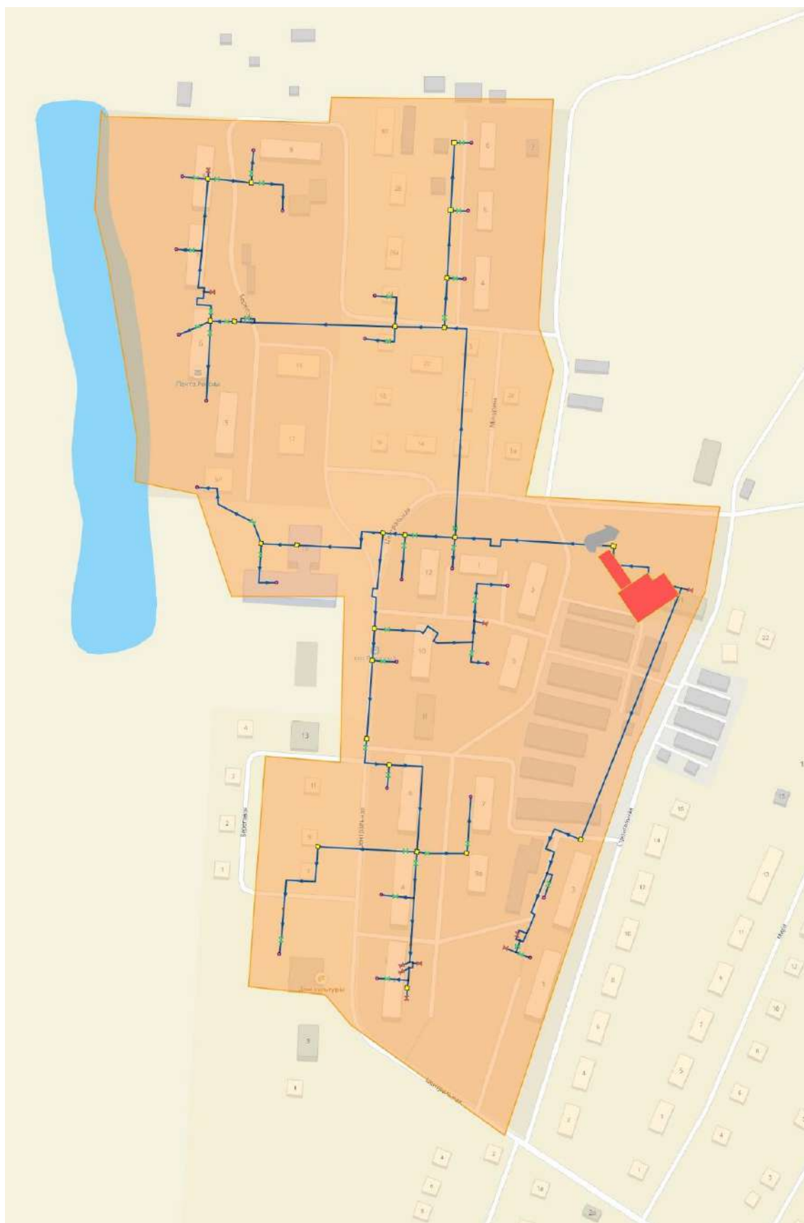
Рисунок 50 – Границы системы теплоснабжения котельной Плодовое
