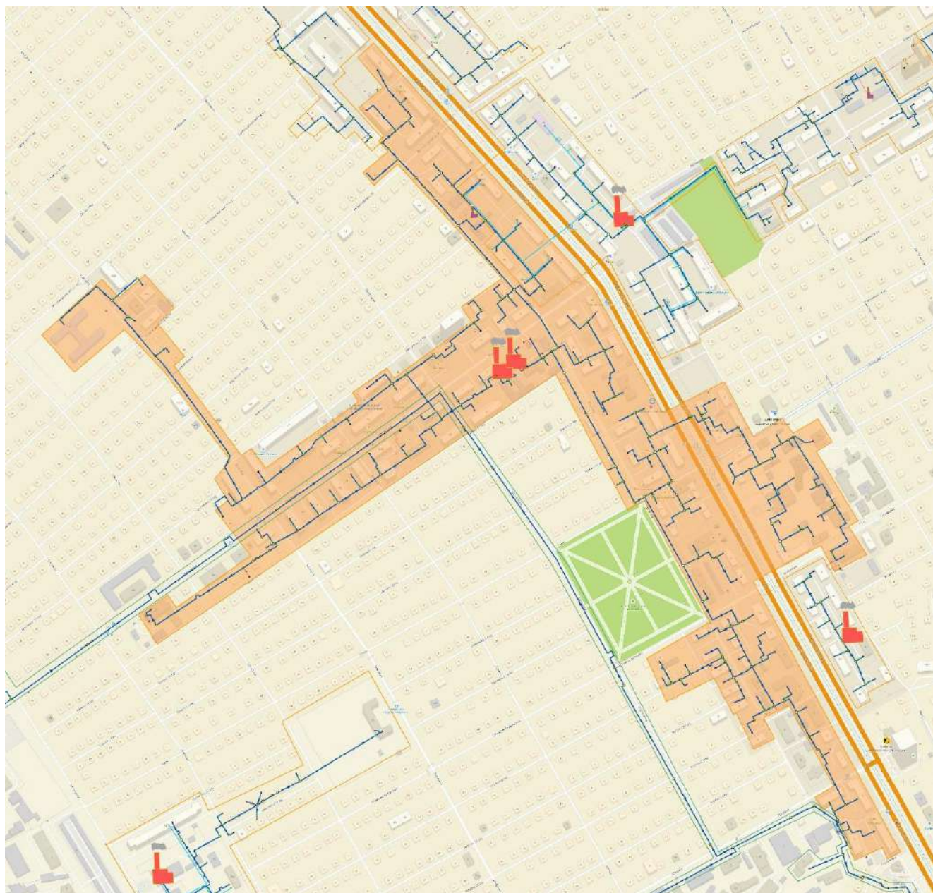
Рисунок 23 – Границы системы теплоснабжения котельной 298 кв.
