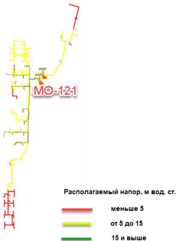
Рисунок 58 – Графическая интерпретация с располагаемым напором системы теплоснабжения котельной «МО-121».
