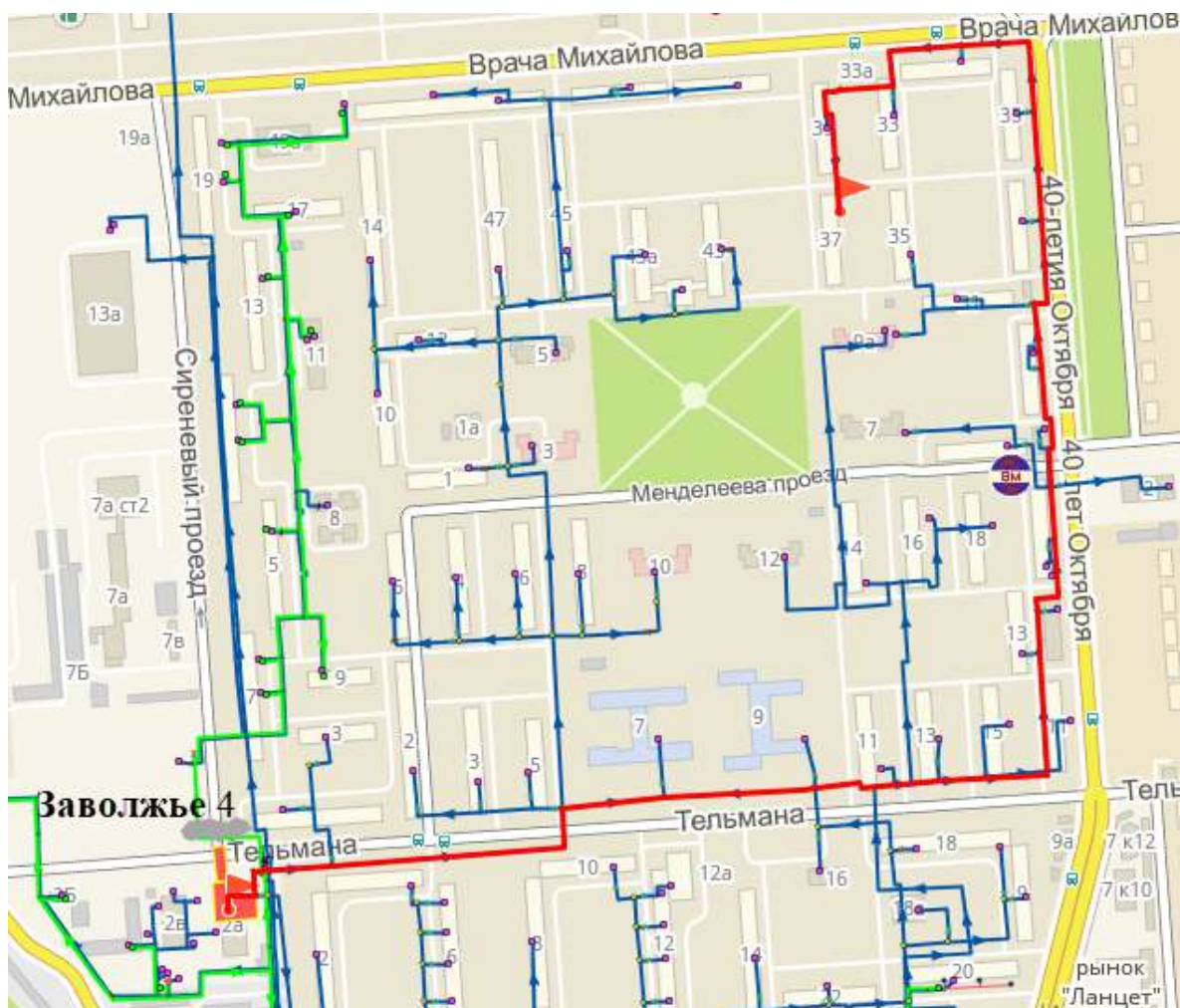
Рисунок 189 – Тепловые сети от котельной Заволжье-4 с пьезометрическим путём до наиболее отдалённого потребителя ул. Врача Михайлова, 37 (1,4 км)
