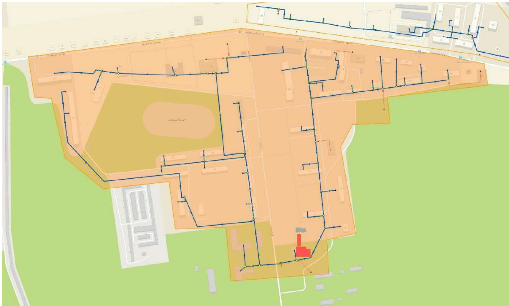
Рисунок 28 – Границы системы теплоснабжения котельной Арсенал
